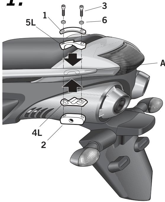
**(E)** En los agarraderos laterales zona (A), posicionar las bridas (4L) y (5L), según nos muestra el dibujo. Y en el lado derecho las bridas (4R) y (5R). Nota: el lado izquierdo se mira montado sobre la moto. A continuación montamos las chapas unión bridas (1) y las escuadras bridas (2), realizaremos un conjunto y lo fijaremos mediante los tornillos (3) y arandelas (6).
