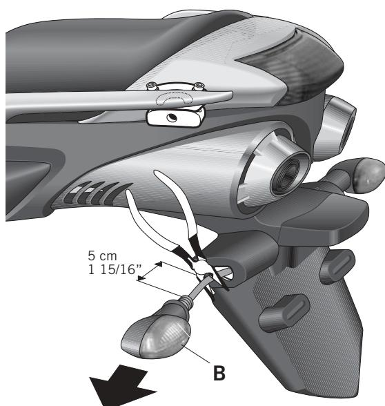
**(E)** Desmontaremos los intermitentes traseros (B) y cortaremos los cables de conexión. Nota: Dejar unos 5 cm de cable en la zona próxima al intermitente para facilitar después el montaje del alargador (17) y luego mas tarde poder realizar la conexión de los soportes KIT SIDE (7).
