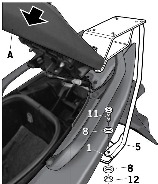
(E) Por último en zona inferior fijarlo al soporte refuerzo (1) mediante los tornillos (11), las arandelas (8) y las tuercas (12). Cerrar el asiento delantero (A).
