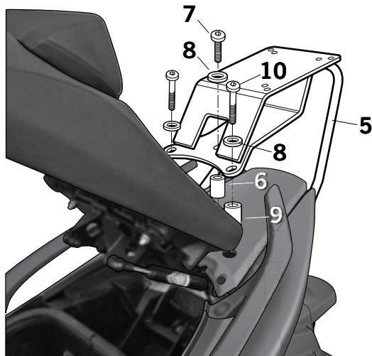
(E) Montar el soporte KIT TOP (5) en zona central superior mediante el distanciador (6), el tornillo (7) y la arandela (8) y en zona superior delantera mediante los distanciadores (9), los tornillos (10) y arandelas (8).
